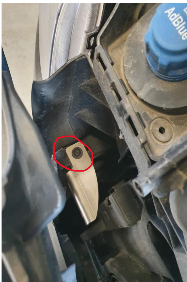
Kuva 1. ylhäältä kiinnike asennettuna
