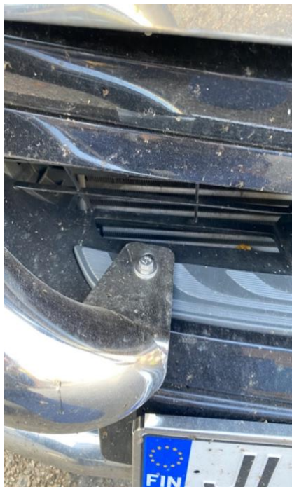
Kuva 4. putkien alapään kiinnitys
